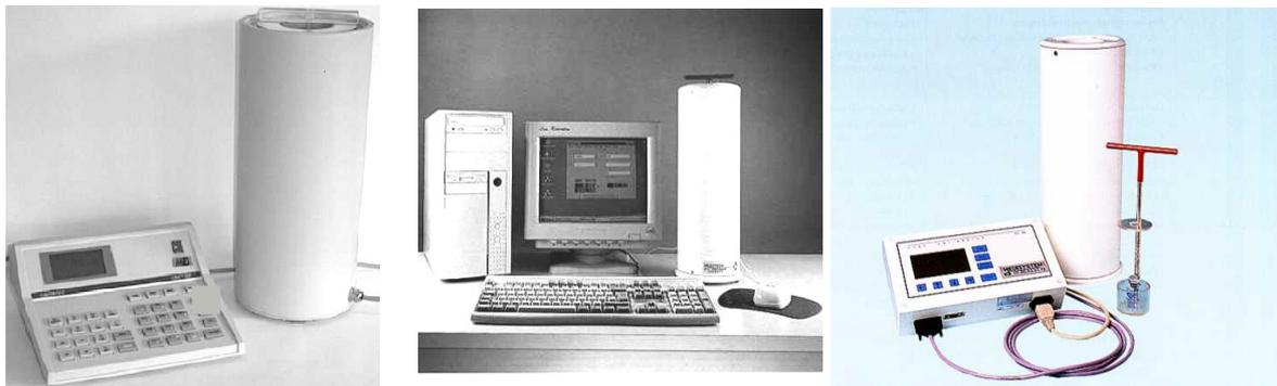
FIG. 1. - Modèles d'activimètre.
